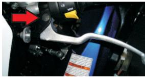
Entfernen Sie die originale Befestigungsschraube indem Sie die Mutter an der Unterseite abdrehen und anschliessend die Schraube herausdrehen.
