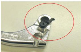
Originale Lagerbuche aus dem Hebel entnehmen und in den MIZU-Hebel mit etwas Fett einsetzen. (Zum Teil wird eine Lagerbuchse mitgeliefert)
