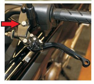
Kupplungsseil in den MIZU-Hebel einhängen und mit etwas Fett und der original Schraube und Mutter mit 6 Nm festschrauben. Das Kupplungsspiel einstellen, ca. 1-2mm
